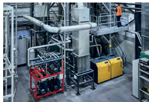
Après le traitement en flocons et granulés, le PET est fondu à 250 degrés.
