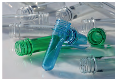
Pour un transport peu encombrant, le PET est d'abord moulé en préformes et celles-ci redeviendront uniquement des bouteilles à l'endroit où elles seront remplies.
