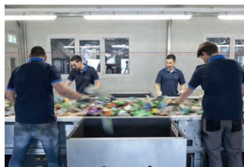
Un degré de pureté de plus de 99,96% peut être atteint grâce à un triage électronique et manuel.
