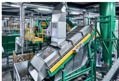
Une fois les étiquettes enlevées, les bouteilles en PET sont nettoyées.
