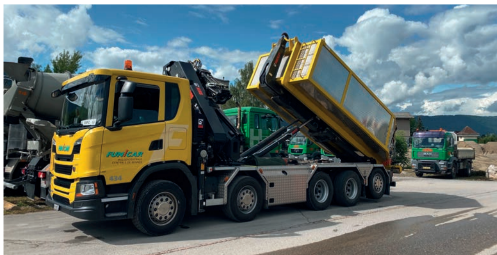
Thermo-benne à deux compartiments en service.
